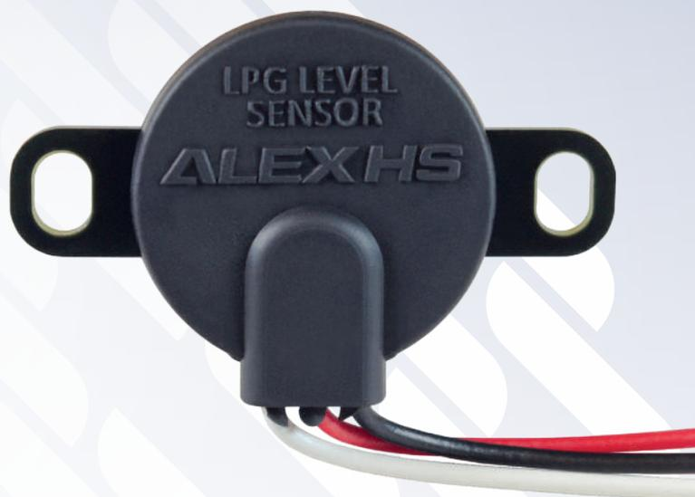
Датчик уровня вычисляет количество газа в баллоне и передает информацию на газовый контроллер. Устройство крепится на мультиклапане. Датчик не имеет механических элементов, состоит из электронной платы с тремя проводами и работает по эффекту Холла. Корпус устойчива водонепроницаем.
