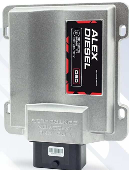
El sistema ALEX DIESEL está basado en la mezcla de 2 combustibles: gasóleo y GLP o GNC. El controlador limita la inyección de gasóleo a una cantidad que permita el encendido espontáneo en el cilindro, y en su lugar proporciona una dosis precisa de gas. **La proporción de gas en una instalación ALEX DIESEL es de media hasta un 30% de GLP o un 50% de GNC.** Estas proporciones de combustible adicional garantizan las condiciones correctas de funcionamiento del motor y de todo el sistema.
