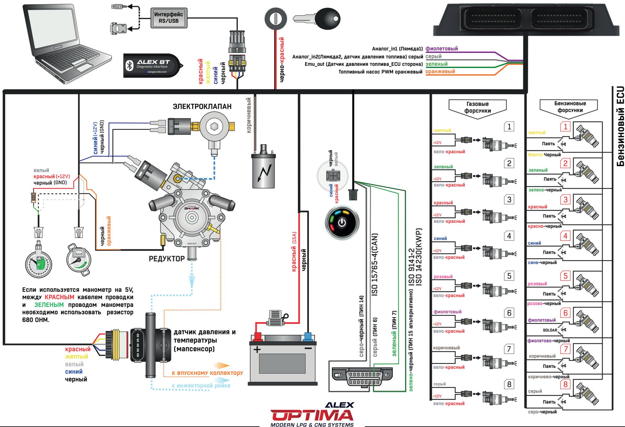
Если используется манометр на 5V, между **КРАСНЫМ** кабелем проводки и **ЗЕЛЕНЫМ** проводом манометра необходимо использовать резистор 680 ОМ.
