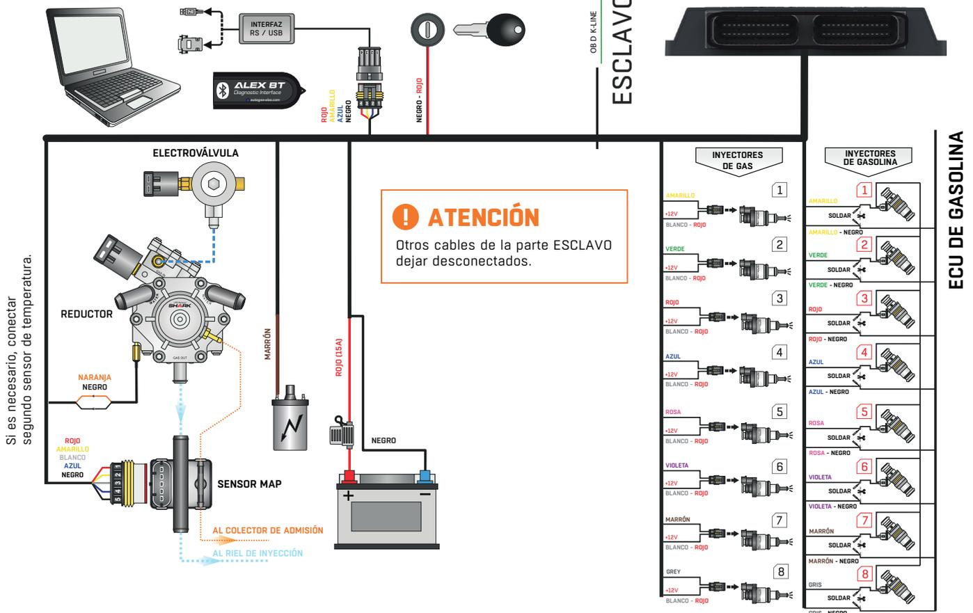
Si es necesario, conectar segundo sensor de temperatura.
