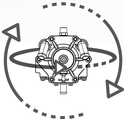
Из-за отсутствия интегрированного электромагнитного клапана и фильтра жидкой фазы, установка редуктора возможна в любом положении, однако мы рекомендуем установку газовым патрубком вниз.
